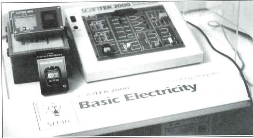
El módulo de electricidad básica permite reproducir un circuito eléctrico.
